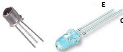
Şekil 1.45: Fototransistör ve bağlantıları
