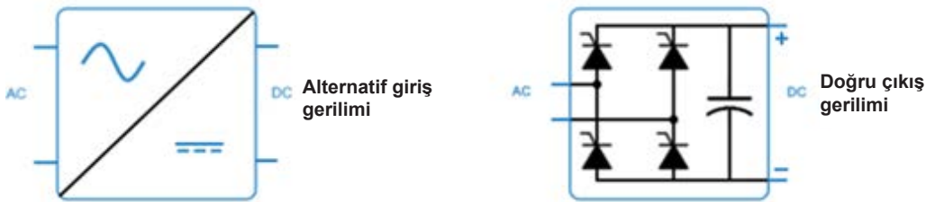
Şekil 6.3: AC/DC dönüştürücünün grafik sembolü ve devresi
