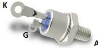
Şekil 1.28: SCR tristörün bağlantıları
