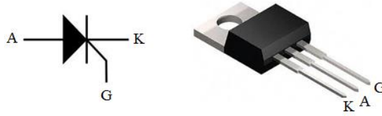
Şekil 1.27: Tristörün grafik sembolü ve bağlantıları
