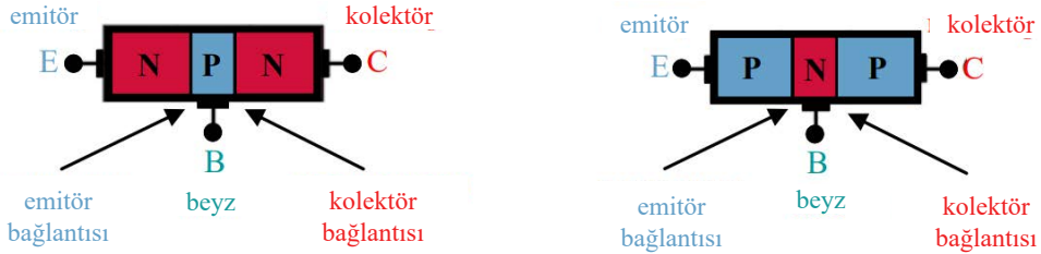
Şekil 3.10: NPN ve PNP türünden transistörlerin PN-bağlantıları
