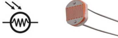
Şekil 1.43: Fotorezistörün grafik sembolü ve gerçek görünümü
