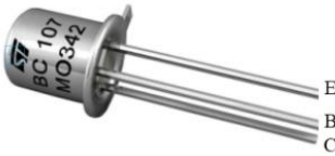
Şekil 14: Transistör terminallerinin sıralanması
