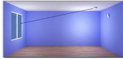
Şekil 6.22: Cam sensörü ve onun kurulması
