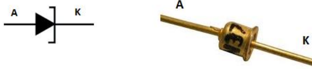
Şekil 1.16: Tünel diyotun grafik sembolü ve bağlantıları
